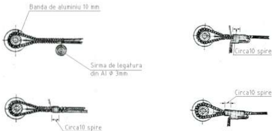
Fig.54. Realizarea legăturii de întindere prin matisare
