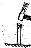
Fig. 13. Bătarea electrozilor verticali, fără folosirea unui sap special, duse la deteriorarea electrozilor.
